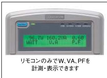
(RC02-PCR-L)またはインターフェースカード(RS11-PCR-L、IB11-PCR-L)の使用により、PF(力率測定)、VA(皮相電力)測定、ピーク・ホールド電流測定が可能になります。ピーク・ホールド電流測定は、ピーク・クリア信号またはコマンドを本機が受け付けるまでの間、ピーク電流の測定を行う機能です。出力ON/OFF位相設定の機能と組み合わせることで、電圧位相を任意に設定しての突入電流測定等が可能になります。
