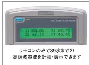
PCR-LシリーズではPCR-L本体とオプションの組み合わせ方により簡易レベルから規格に準拠できるレベルまで、ユーザの予算にあわせながら、また将来の拡張・変更にも対応できるシステムの構築を可能にしています。尚、リモートコントローラ(RC02-PCR-L)のみで1次~39次の高調波電流の簡易測定が可能です。手軽な予備試験用としてお使いいただくことができます。
