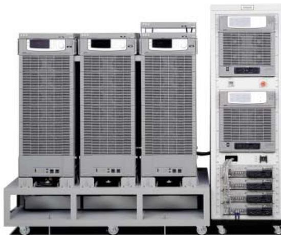
●三相高調波電流測定システムの構築例(18kVA)。この例のような電源の架台製作やラックアップも特注にてお請けいたします。
